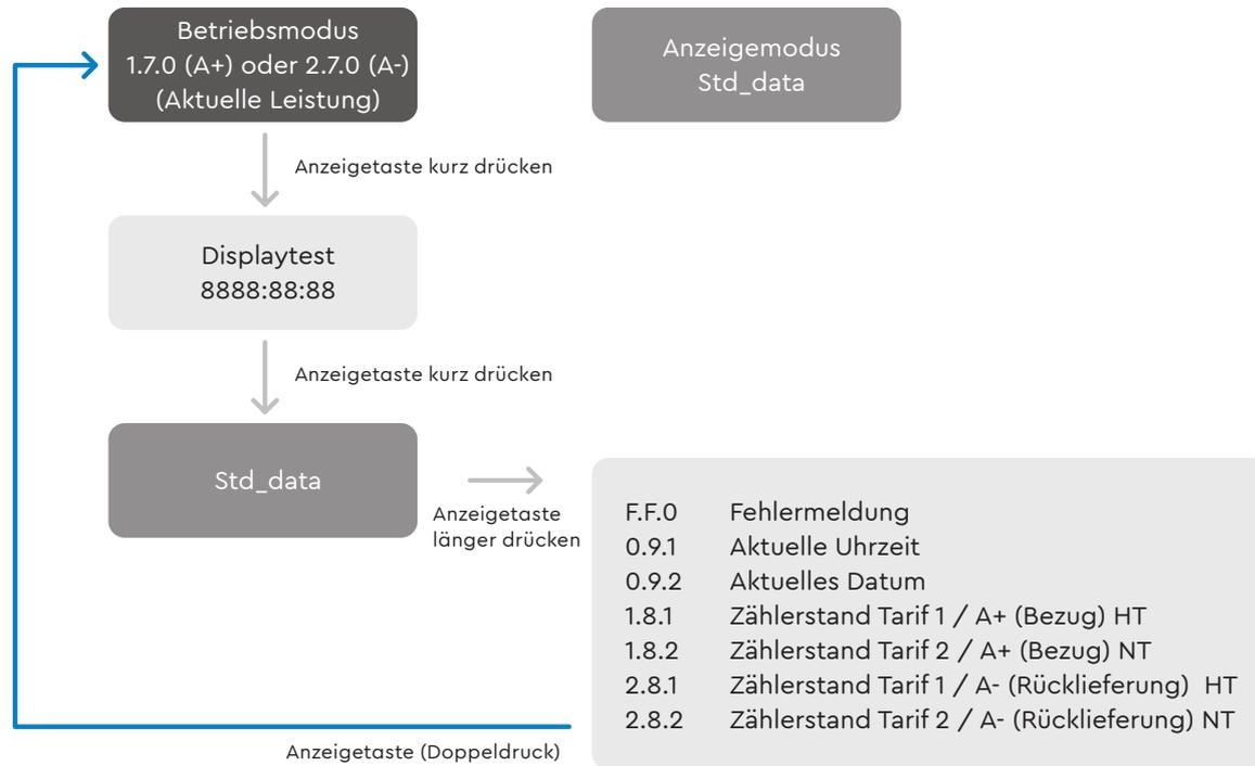
Die Datenanzeige wechselt nach einer Minute automatisch in den Betriebsmodus zurück.
